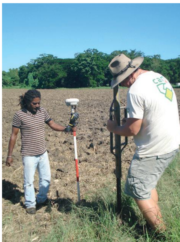
Raymond Wassingalu, technicien géomètre. Piquetage de parcelle sur le périmètre agricole locatif de Pocquereux, La Foa.
